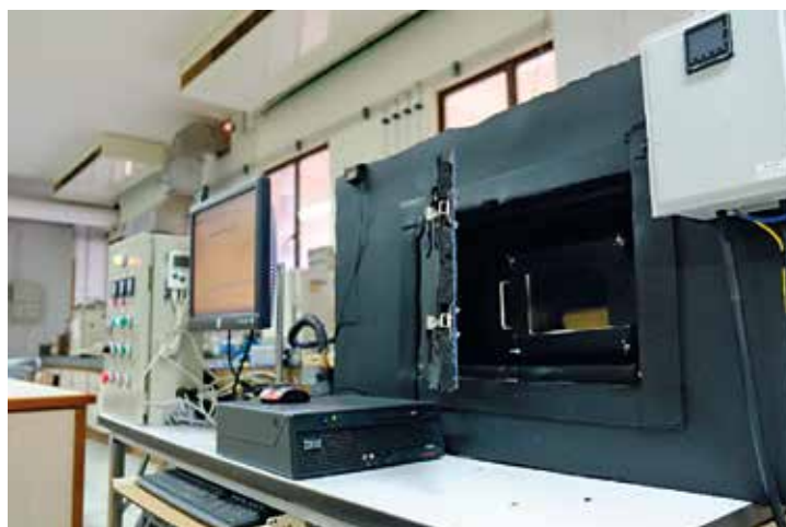
รูปที่ 8 กล่องปิดหีบครอบตู้ทดสอบไว้ ซึ่งอุณหภูมิภายในกล่องปิดนี้สามารถปรับตั้งค่าให้อยู่ในช่วงใกล้เคียงกับอุณหภูมิที่ต้องการภายในตู้ทดสอบ
