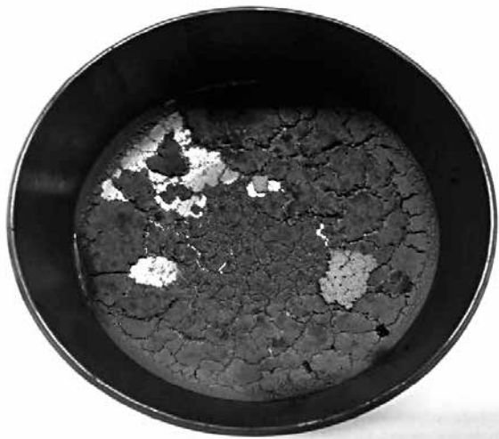
รูปที่ 3 ลักษณะของของแข็งที่เหลือจากการไพโรไลซิส ถุงมือยางที่อุณหภูมิ 500 องศาเซลเซียส
