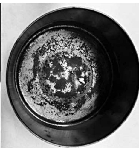
รูปที่ 2 แสดงผลิตภัณฑ์ที่เป็นของเหลวและผลิตภัณฑ์ของแข็งที่อุณหภูมิ 450 องศาเซลเซียสจากการไพโรไลซิสสูงพลาสติกชนิดพอลิเอทิลีนความหนาแน่นสูง
