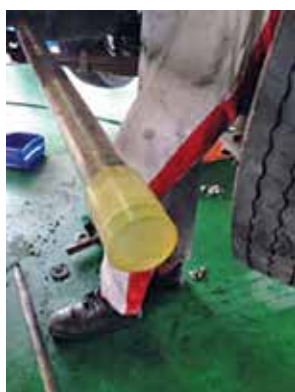
รูปที่ 3 เหล็กส่งแรงที่ปิดหัวเหล็กด้วย TPU
