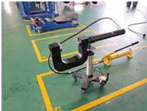
รูปที่ 2 เครื่องทดสอบสลักแบบระบบไฮดรอลิก
