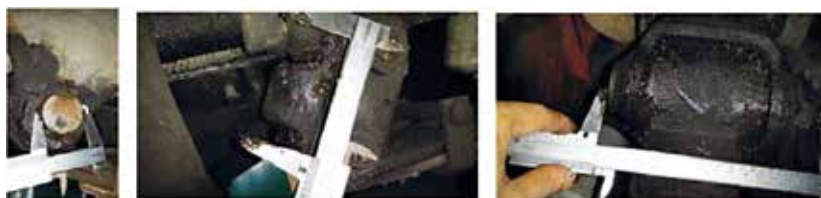
รูปที่ 1 ศึกษาตำแหน่งและ ขนาด ของสลักแหวนของรถบรรทุก 10 ล้อ รุ่น FM-Series
