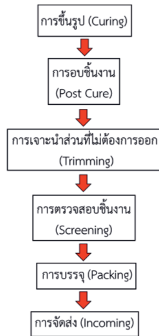
ภาพที่ 2 กระบวนการผลิตยางสังเคราะห์
