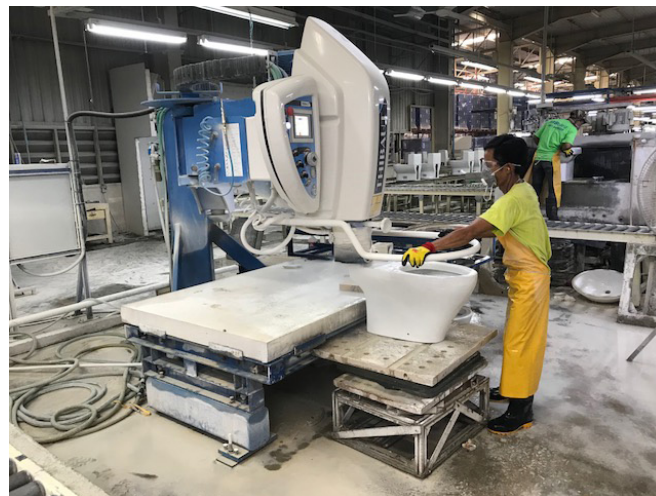
ภาพที่ 3 เครื่องเจียรหล่อ่น้ำ (Water Grinding Machine)
