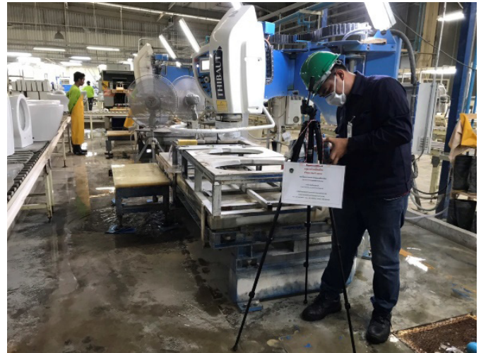
ภาพที่ 4 จุดตรวจวัด Respirable Dust ในพื้นที่คัดแยกชิ้นงานสุขภัณฑ์หลังทำการปรับปรุง
