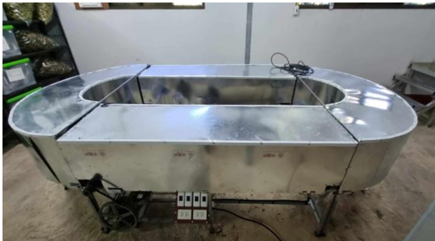
รูปที่ 2 แสดงเครื่องฉายรังสี UV-C ลักษณะตู้ฉายแบบอุโมงค์ที่ทำการผลิตในการศึกษาครั้งนี้
