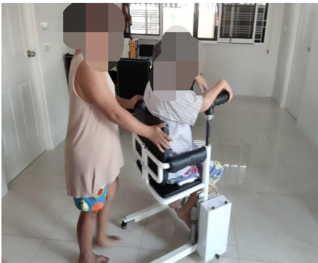
ภาพประกอบที่ 4 นวัตกรรมเก้าอี้ยกและเคลื่อนย้ายผู้สูงอายุเพื่อลดความเสี่ยงทางกายศาสตร์จากท่าทางการทำงานของผู้ดูแล
