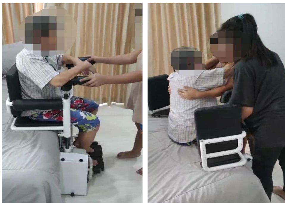
ภาพประกอบที่ 5 แสดงการทดลองใช้เก้าอี้ยกและเคลื่อนย้ายผู้สูงอายุเข้าเตียงนอน
