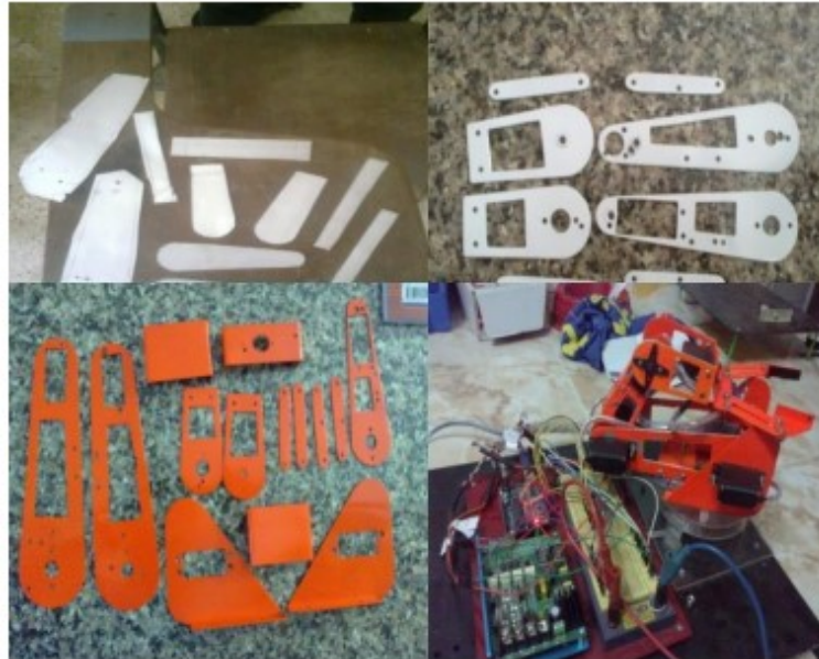
ภาพที่ 5 การตัด เจาะ แผ่นอะลูมิเนียมเพื่อการพับสี การประกอบแขนกลอัตโนมัติขนาดเล็ก
