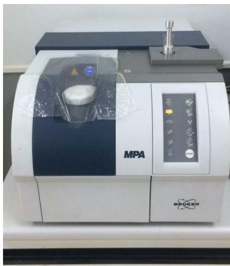
ภาพที่ 1 การเก็บข้อมูลเนียร์อินฟราเรดด้วยเครื่อง FT-NIR spectrometer (MPA, Bruker, Germany)
