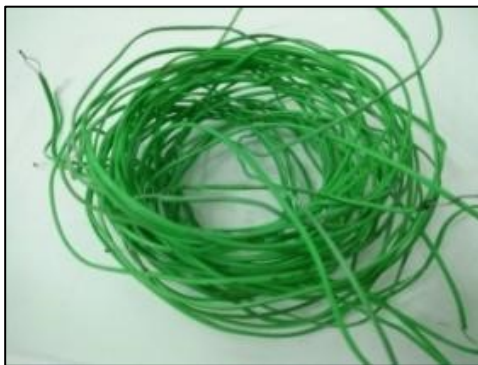
ภาพที่ 4 สายเทอร์โมคัปเปิลยี่ห้อ OMEGA ชนิด K
