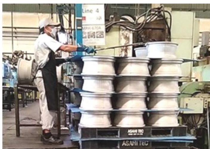
ภาพที่ 4 ปรับปรุงสภาพการทำงานให้พนักงานใช้เหล็กด้ามยาวส่วนปลายมีขอสำหรับเกี่ยววงล้อ ที่มา : บันทึกภาพโดย เคียวสุเกะ (วรวิทย์) พุกมั่ง
