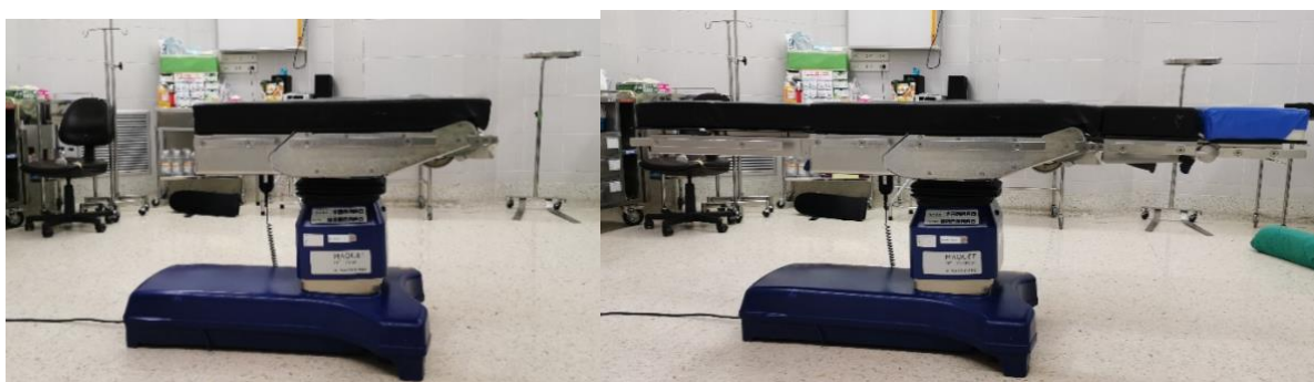
ภาพที่ 15 การต่อเตียงกลับด้านจากด้านศีรษะมาเป็นด้านเท้า
