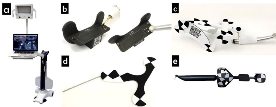
รูปที่ 4 ส่วนประกอบของเครื่องมือนำทางโดยใช้ระบบคอมพิวเตอร์ช่วยเหลือแบบพลวัต (a) เครื่องควบคุมระบบนำทาง; (b) ตัวปรับเทียบ; (c) อุปกรณ์แสดงตำแหน่งด้ามกรอ; (d) อุปกรณ์แสดงตำแหน่งของผู้ป่วย; (e) เครื่องมือติดตาม (ปรับปรุงภาพมาจาก Bardales-Alcocer, et al. (2021) (58))
